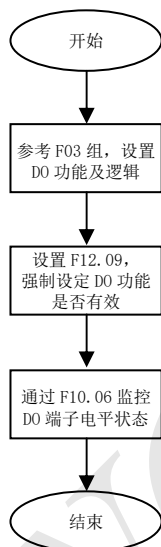
图 5-11 D0 信号强制输出设定步骤示意图
