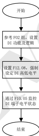
图 5-8 DI 信号强制输入设定步骤示意图
