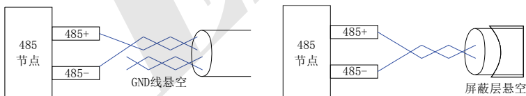
图 10-11 无 GND 时的接线示意图
