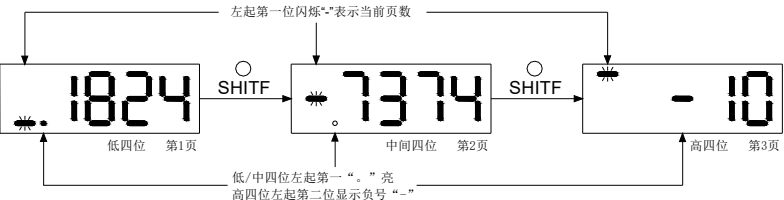
图 5-3 -1073741824 显示操作示意图
