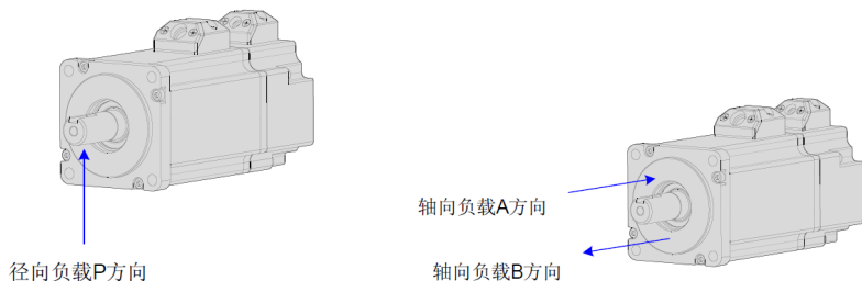
图 2-6 电机径向及轴向负载示意图
