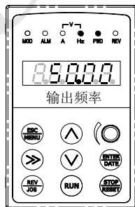
图 c 运行状态，显示 运行状态参数
