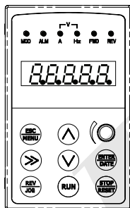
图 a 上电初始化， 显示 8.8.8.8.8.
