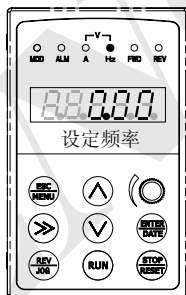
图 b 待机状态，显示 待机状态参数
